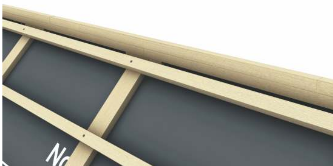
fig. 12 Montarea șipcilor pentru coama orizontală
