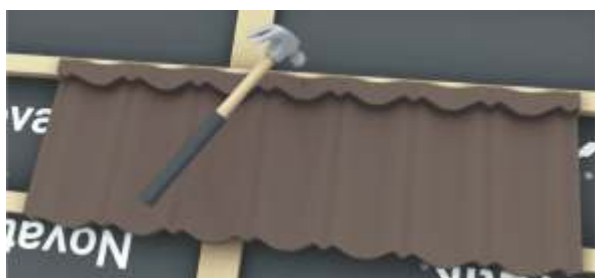
fig. 15 - Fixarea rândului 2 din zona de coamă
