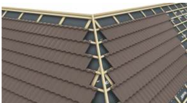
fig. 23 - Montarea modulelor în zona coamei oblice
